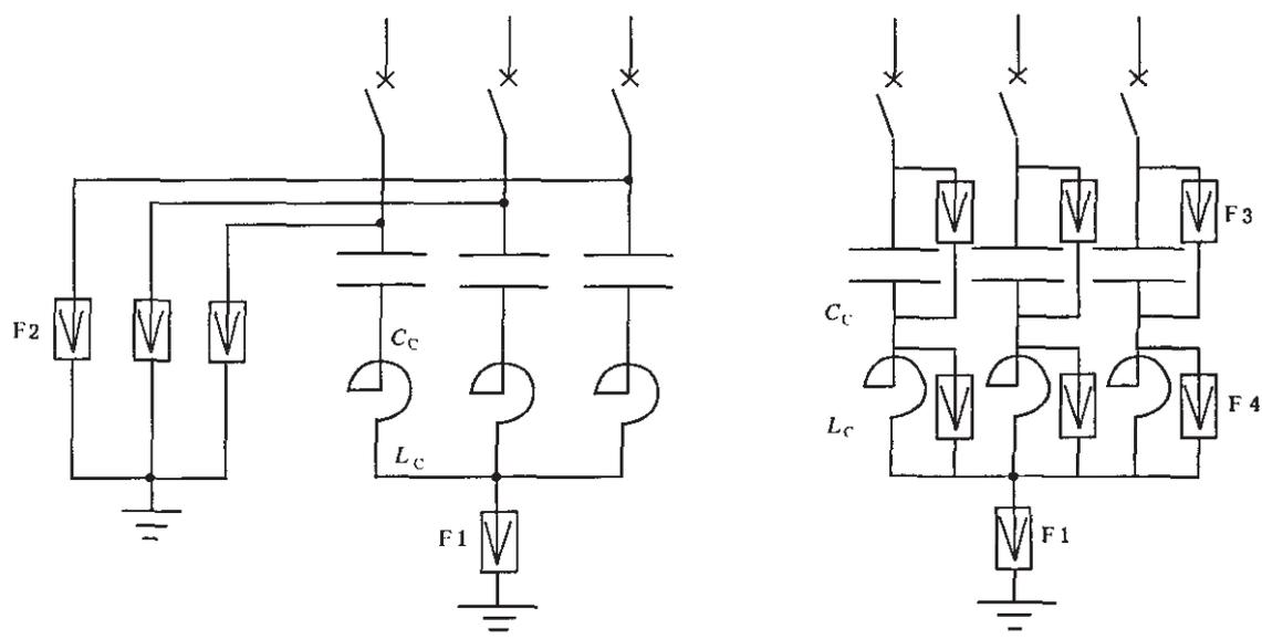
a) 单相重击穿过电压的保护接线
