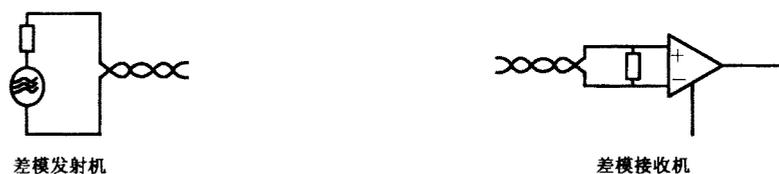
图 A.6 采用差模方式的信号传输
